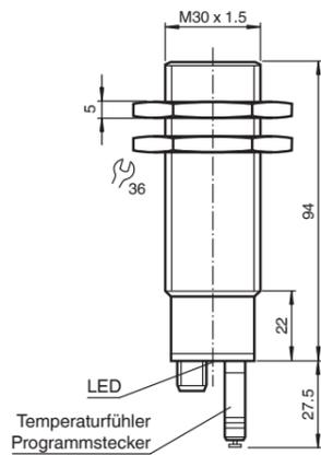
Alle Abmessungen in mm
