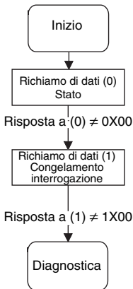
Diagnostica dei moduli circuito di uscita 1
