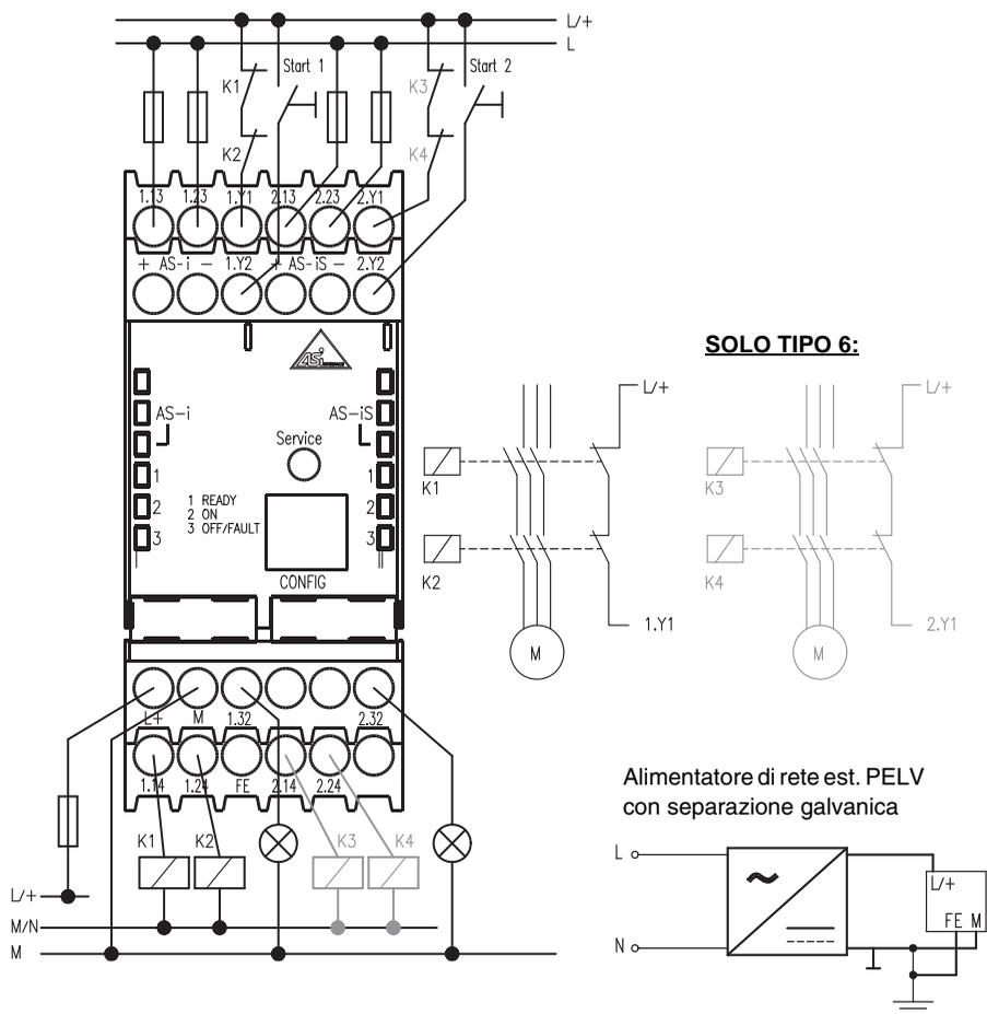
Figura 7.2: Schema dei collegamenti monitor di sicurezza AS-interface tipo 5 e tipo 6
