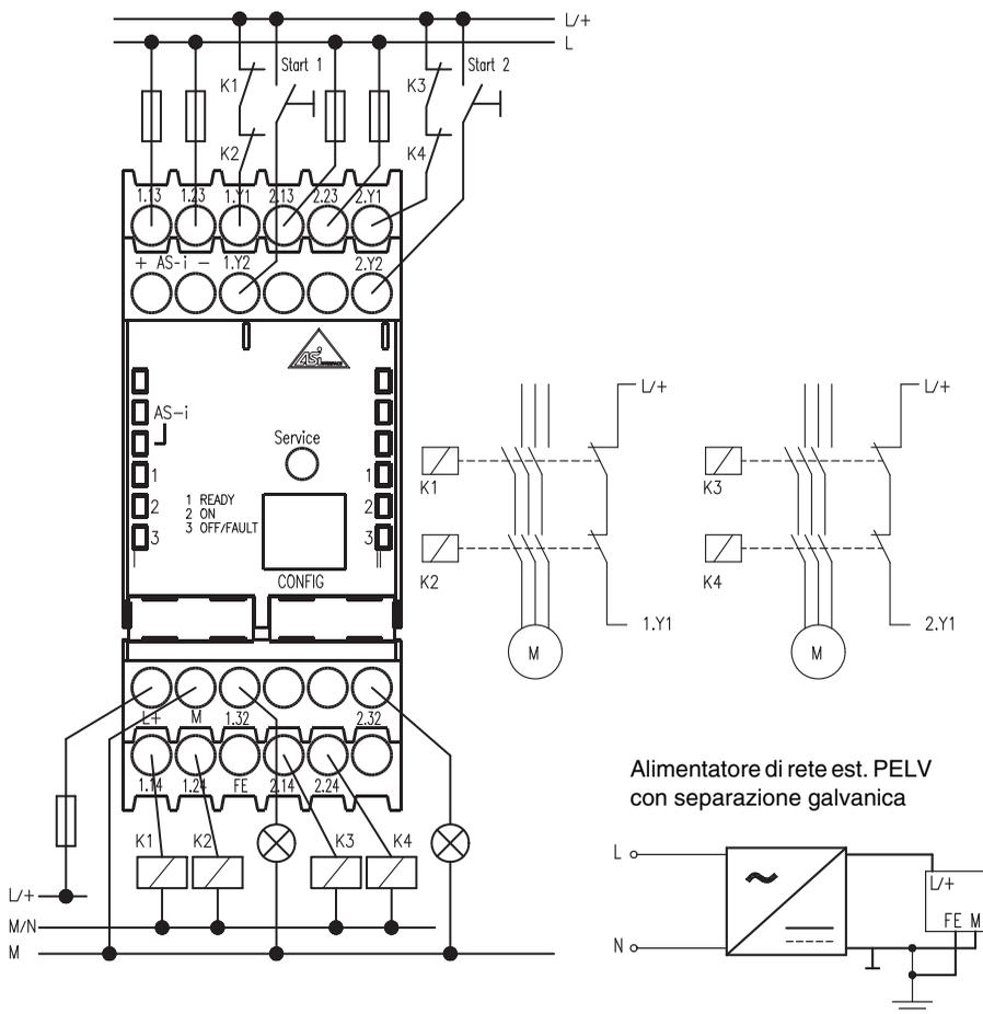
Figura 6.2: Schema dei collegamenti monitor di sicurezza AS-interface tipo 2 e tipo 4
