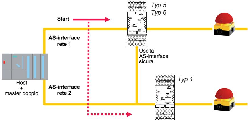
Figura 1.3: Esempio: Accoppiamento orientato alla sicurezza di 2 reti AS-interface
