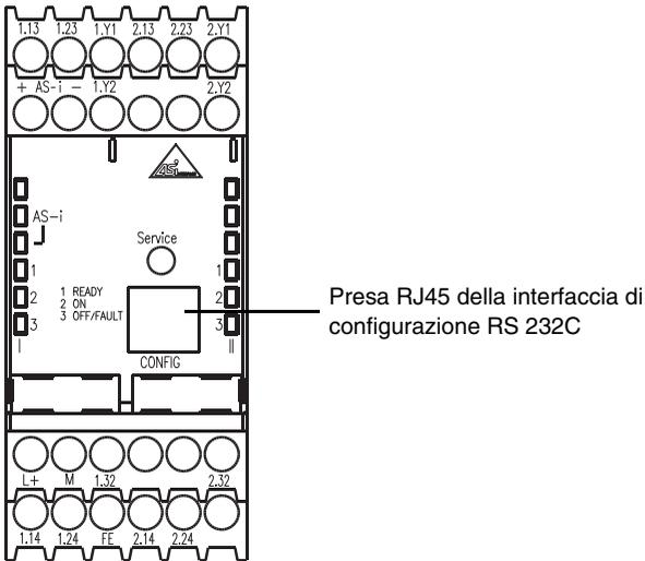
Figura 8.2: Posizione dell'interfaccia di configurazione RS 232C
