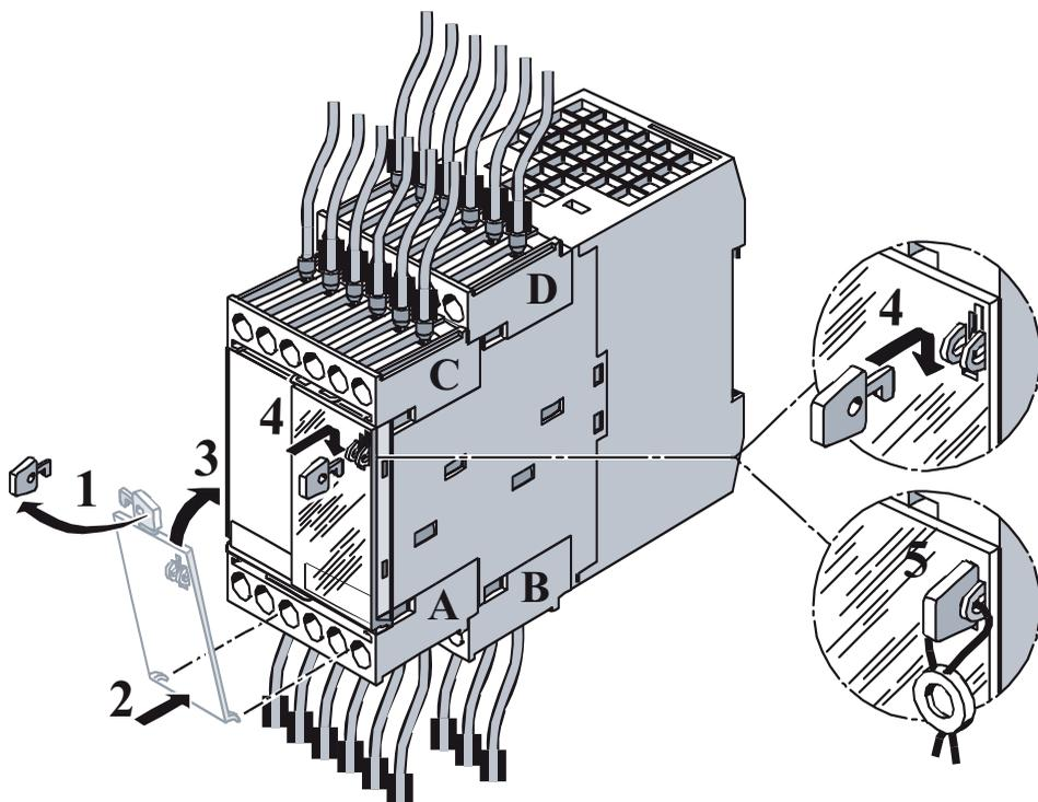
Figura 4.4: Accessori di montaggio per la piombatura dell'apparecchio
