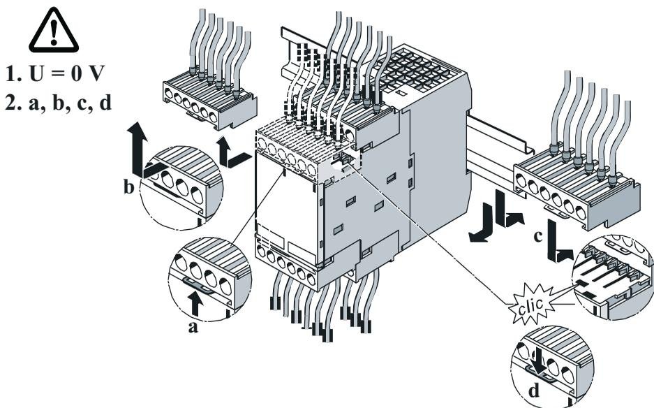
Figura 4.3: Smontaggio e montaggio dei morsetti codificati
