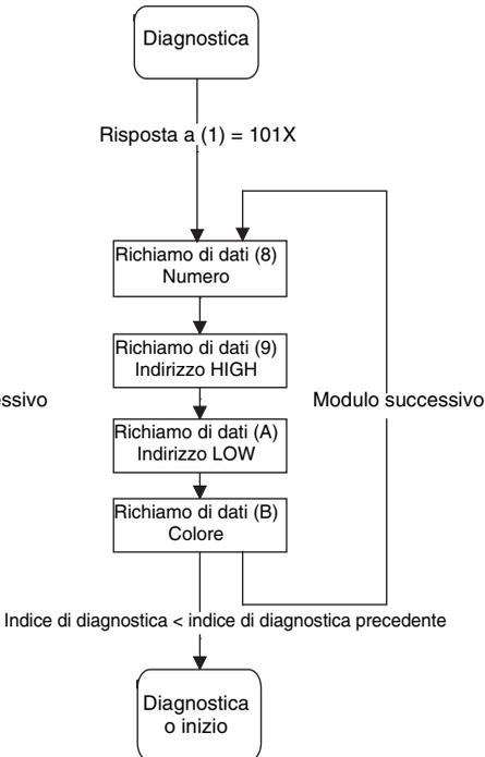
Figura 12.1: Schema di interrogazione della diagnosi ordinata per circuiti di uscita
