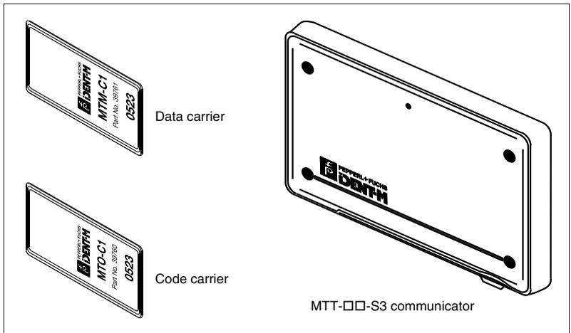
Bild 4.1: IDENT-M System T components
