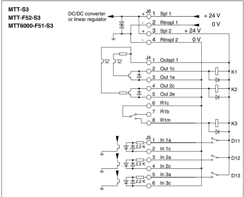
Bild 5.9: Wiring of the inputs and outputs
