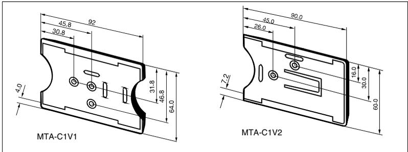
Bild 4.6: MTA-C1V1 and MTA-C1V2 card holders
