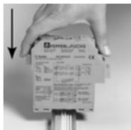
Die Geräte des K-Systems von Pepperl+Fuchs und so auch die Messumformer KFD2-WAC2-(Ex)1.D können auf einer 35 mm Normschiene nach EN 50022 montiert werden. Dabei schnappen Sie die Geräte einfach **senkrecht** auf, keinesfalls gekippt/schräg von der Seite.
