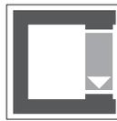
Ist zwischen Sender und Empfänger nur eine geringe räumliche Distanz - wenige Millimeter oder Zentimeter (lieferbar bis 220 mm) - zu überbrücken, können beide gegenüberliegend in einem u-förmigen Gehäuse untergebracht werden. Solche Gabellichtschraken (siehe Abb.) weisen gegenüber normalen Einweg-Lichtschraken den Vorteil einer einfacheren elektrischen Installation auf, da nur ein Gerät zu verkabeln ist. Außerdem entfällt die Justierung der optischen Achsen.
