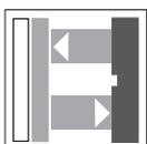
Reflexions-Lichttaster mit Hintergrundaussblendung wurden entwickelt, um eine definierte Tastweite bei beliebigen Objekten zu erreichen - unabhängig von deren Helligkeit, Farbe und sonstiger Beschaffenheit sowie der Helligkeit des Hintergrunds.
