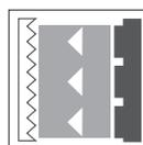
Eine Flächen-Lichtschranke enthält mehrere Sender und Empfänger in einem Gehäuse und bildet über die jeweilige Reichweite mit einem gegenüberliegenden Reflektor ein durchgehendes breites bzw. hohes Detektionsfeld.
