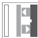
Reflexions-Lichttaster mit Hintergrundunterdrückung arbeiten ähnlich wie Reflexions-Lichttaster mit Hintergrundaussblendung - der Abstand zwischen Objekt und Hintergrund ist jedoch größer. Durch dieses Zugeständnis an die Trennschärfe ist es möglich diese Geräte mit einem sehr attraktiven Kosten-/Nutzen-Verhältnis anzubieten. Sie sind die erste Wahl, wo trotz hohem Kostendruck in der Anwendung nicht auf die Ausblendung eines vorhandenen Hintergrunds verzichtet werden kann.
