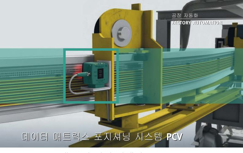
2-D 코드 밴드 및 최신 카메라 기술을 이용한 신뢰성 있는 위치 감지 시스템
