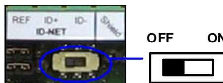
Figure 9 – ID-NET™ Termination Resistance Switch
