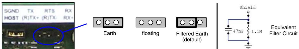
Figure 8 – ID-NET/Host Shield Jumper Settings
