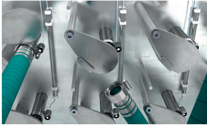
RFID 시스템으로 호스의 연결 상태 모니터링(방폭)
