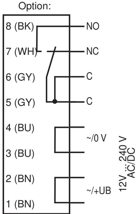
Die Relais-Funktionen "Öffner" und "Schließer" beziehen sich auf die Schaltungsart "Hellschaltung", in deren Stellung sich der Hell-/ Dunkelumschalter auf der Gehäuserseite befindet (= Auslieferungszustand).
