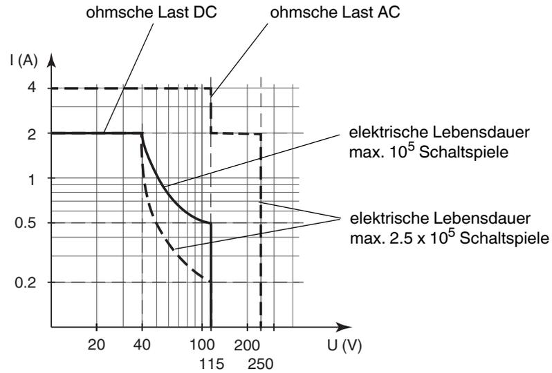
Die maximale Anzahl der Schaltspiele hängt von der elektrischen Last ab und kann höher sein, wenn reduzierte Ströme und Spannungen anliegen.
