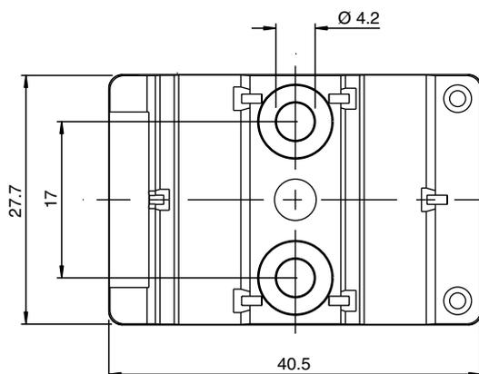
Sie können das Gerät mit zwei Befestigungsschrauben M4 auf einer planen Montagefläche festschrauben. Die Befestigungsschrauben liegen nicht bei.
