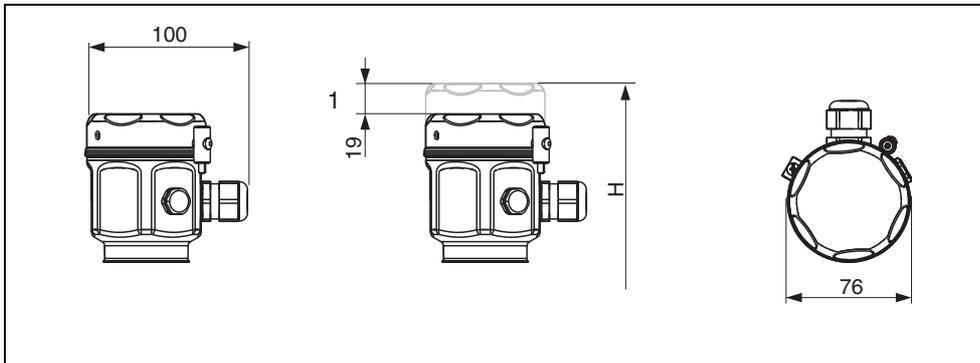
1 Der Deckel mit Sichtfenster ist 19 mm (0,75 in) höher als der Deckel ohne Sichtfenster.
