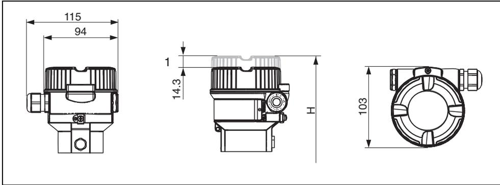
1 Der Deckel mit Sichtfenster ist 15 mm (0,59 in) höher als der Deckel ohne Sichtfenster.
