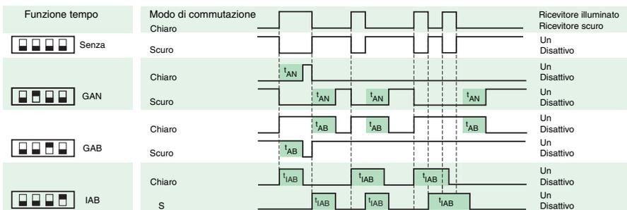
i tempi  $t_{AN}$ ,  $t_{AB}$  e  $t_{IAB}$  sono regolabili tra 0,1 s e 10 s
