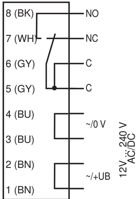
Le funzioni del relè "contatto di riposo" e "contatto normale aperto" si riferiscono alla configurazione circuitale "blanking", nella cui posizione si devono trovare i due commutatori unblanking/blanking (= condizione in fase di consegna).
