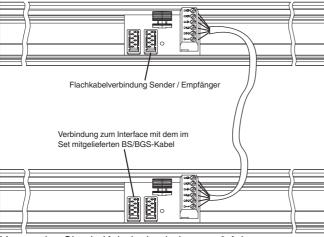
Verwenden Sie ein Kabel mit mindestens 6 Adern. Der Aderquerschnitt kann zwischen 0,128  $\text{mm}^2$  ... 1,0  $\text{mm}^2$  (~AWG 18) liegen
