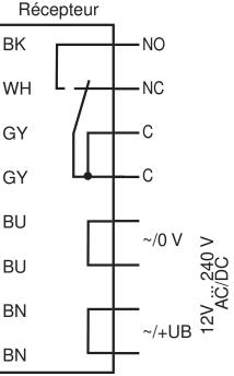
Les fonctions relais "contact d'ouverture" et "contact de fermeture" se rapportent au mode de commutation "Commutation foncé", position que les deux inverseurs clair/foncé doivent avoir (= réglage d'origine).
