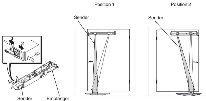
Der Sender jedes Sensors hat 2 Rastereinstellungen, mittels der die Überwachungskante links- oder rechtsbündig eingestellt werden kann.
