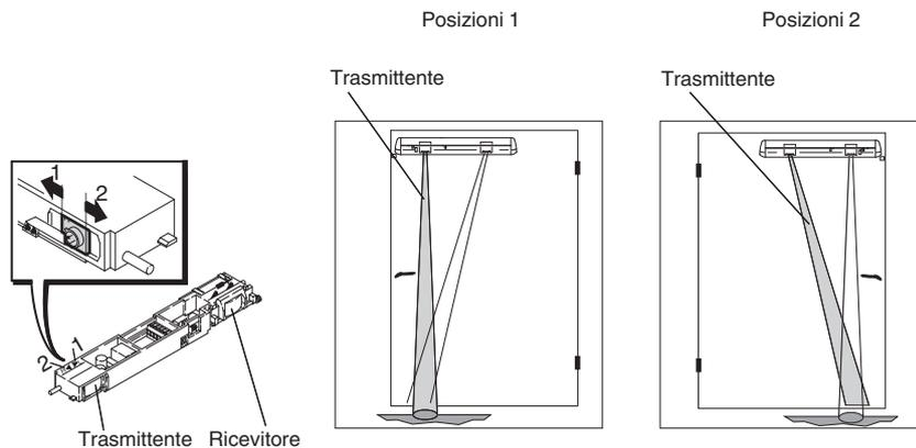
Il trasmettitore di ciascun sensore presenta due impostazioni della posizione del fascio, tramite le quali è possibile allineare il bordo di monitoraggio a sinistra o a destra.
