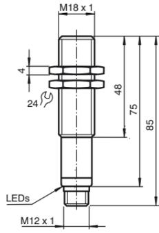
Alle Abmessungen in mm
