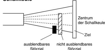
Die Ausblendung eines Störziels wird durch eine Reduzierung der Ansprechempfindlichkeit erreicht. Die nebenstehende Abbildung zeigt deren Auswirkung auf die Ansprechcharakteristik des Sensors. Die Werkseinstellung des Sensors ist Stufe 1.
