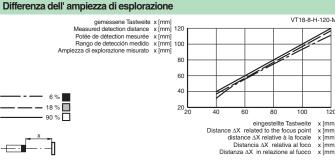
Charakteristische Ansprechkurve Courbe de response caractéristique Curve di risposta caratteristica
