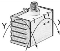
Die Schießfunktion (Ausgang aktiv) ist stets definiert als der Bereich zwischen der ersten und der zweiten parametrisierten Schaltposition im Uhrzeigersinn von der ersten Schaltposition aus gesehen. Beispiel:
