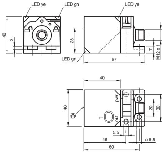
Alle Abmessungen in mm
