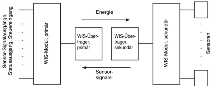
Die Summe der Ruhestrome aller an das WIS-Modul, sekundär angeschlossenen Sensoren darf nicht größer sein, als der maximal übertragbare Strom. Dieser errechnet sich aus der durch die Übertrager gegebenen übertragbaren Leistung / 12 V.
