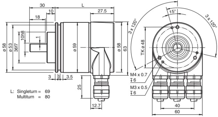
**Abmessungen, Servoflansch / Dimensions, servo flange**
