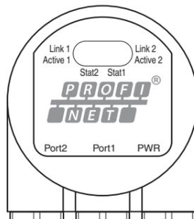
\* blinkt mit 2 Hz während eines Identifikationsaufrufs während der Projektierung bei bestehender Link-Verbindung.
