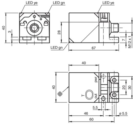
Alle Abmessungen in mm
