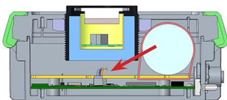
3. Stecken Sie das Anschlusskabel der Batterie auf der Hauptplatine in einen der weißen Steckverbinder. Da die Leitungen intern verbunden sind, spielt die Steckposition keine Rolle.
