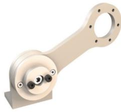
Der Federarm MBT-36ALS120 ist für den Einsatz von Messrädern zwischen 300mm und 500mm Umfang an Drehgebern mit 58 mm Durchmesser geeignet. Durch die innovative 6 Loch Befestigung ist eine störungsfreie Kabelführung möglich.
