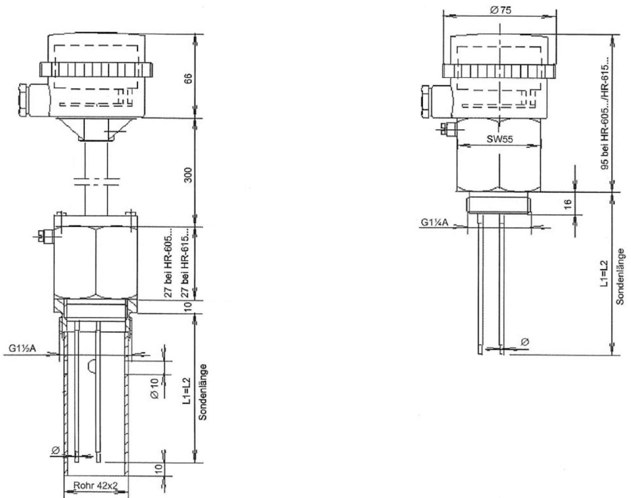
Schematischer Aufbau der Überfüllsicherung:
