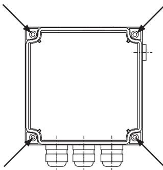
3. Revisser le capot de protection de l'appareil si les travaux de raccordement ne sont pas effectués immédiatement.
