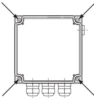
3. Schrauben Sie die Geräteschutzabdeckung wieder an, falls Sie nicht sofort die Anschlussarbeiten durchführen.
