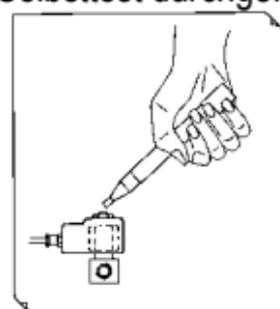
Kommt man in die Nähe eines Magnetfeldes, z.B. eines Magnetventils, leuchtet die Spitze des Magnet-Ex 12 auf.
