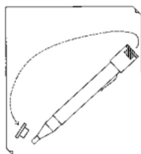
Mit Hilfe des Testmagneten wird ein Selbsttest durchgeführt.
