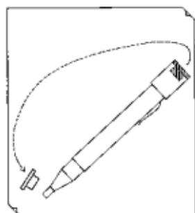
Tramite il magnete di prova viene eseguito un test autodiagnostico.
