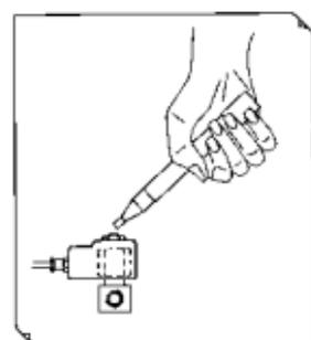
Lorsque que l'on approche d'un champ magnétique, par exemple d'une électrovanne, la pointe du Magnet-Ex 12 s'allume.
