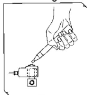
Se la sonda viene collocata nei pressi di un campo magnetico, ad esempio quello di un'elettrovalvola, l'indicatore LED della sonda si illumina.
