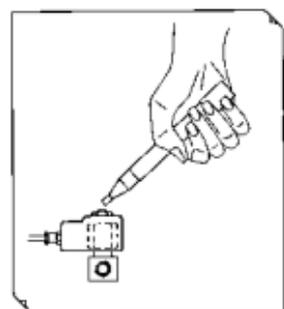
Si la sonda se coloca cerca de un campo magnético, por ejemplo de una válvula solenoide, el indicador LED de la sonda se encenderá.
