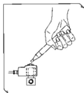
Se a sonda for colocada próximo de um campo magnético, por exemplo de uma válvula solenóide, o indicador LED da sonda acende.
