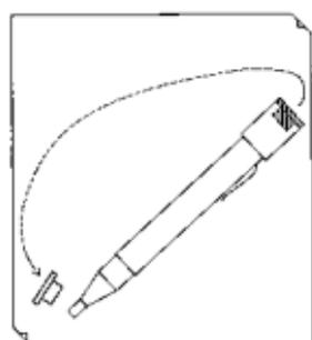
Usando el imán de prueba, se realiza una autocomprobación.
