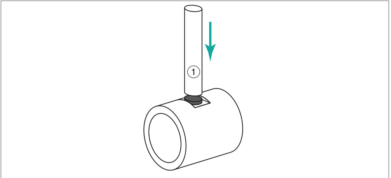
5. Der Transponder sollte vollständig bis zum Boden der Bohrung eingeführt sein. Er sollte etwas tiefer (0,5 mm) als die Rohrleitungsoberfläche liegen, damit er gut geschützt ist.
