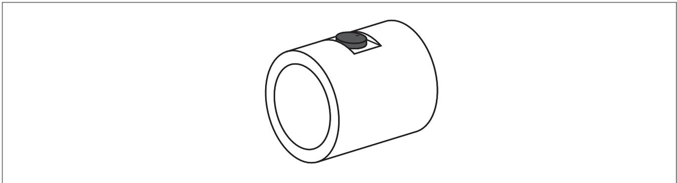
3. Verwenden Sie ein Treiberwerkzeug um den Transponder in die Bohrung zu pressen. Zum Schutz des Transponders während des Einpressens wird empfohlen eine Aussparung am Kopf des Treiberwerkzeugs (gemäß den unten angegebenen Abmessungen) zu schaffen.
