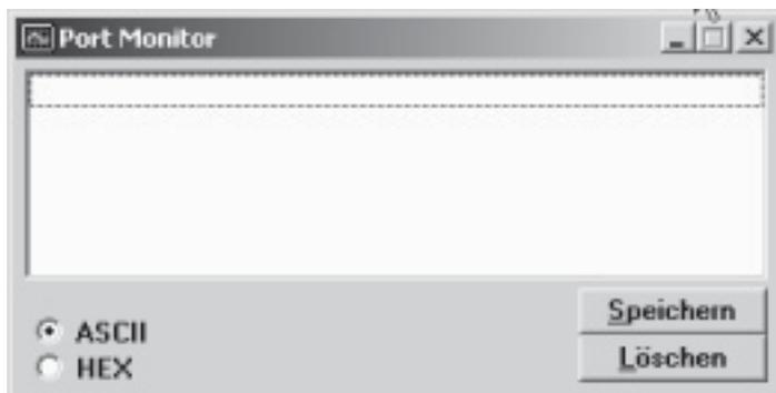
Der **Port Monitor** protokolliert die gesamte Kommunikation über die serielle Schnittstelle. Sie können zwischen **ASCII** und **HEX** Darstellung wählen. In der ASCII Darstellung werden nicht darstellbare Zeichen durch ihr Synonym (ASCII 3 = <ETX>) ersetzt.
