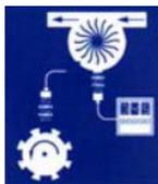
Les appareils de surveillance de survitesse/sous-vitesse KF\*\*-DWB-(Ex)1.D du Système K (forme abrégée : DWB) sont généralement utilisés pour assurer le respect des valeurs limites lors des mesures du débit et de la vitesse de rotation (alarme Max et alarme Min).
