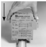
Les appareils du Système K de Pepperl+Fuchs, y compris l'unité de surveillance de sur vitesse/sous-vitesse KF\*\*-DWB-(Ex)1.D peuvent être montés sur un rail standard de 35 mm, conformément à la norme DIN EN 60175. Les appareils doivent être insérés **verticalement** sur le rail, sans jamais être inclinés ou penchés sur le côté.
