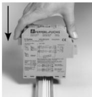
Les appareils du système K de Pepperl+Fuchs, y compris le Convertisseur de fréquence avec valeurs de déclenchement KF\*\*-UFC-(Ex)1.D, peuvent être montés sur un rail standard de 35 mm, conformément à la norme DIN EN 60175. Les appareils doivent être insérés **verticalement** sur le rail, sans jamais être inclinés ou penchés sur le côté.
