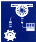
Les applications types du convertisseur de fréquence universel KF\*\*-UFC-(Ex)1(D) du Système K sont des mesures de débit et de régime (nombre de tours par minute).
