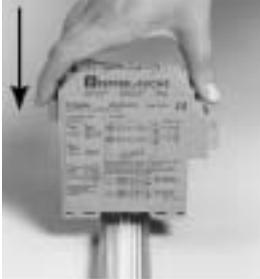
Die Geräte des K-Systems von Pepperl+Fuchs und so auch die Messumformer KFD2-UT-(Ex)1(-1) können auf einer 35 mm Normschiene nach DIN EN 50022 montiert werden. Dabei schnappen Sie die Geräte einfach **senkrecht** auf, keinesfalls gekippt / schräg von der Seite.
