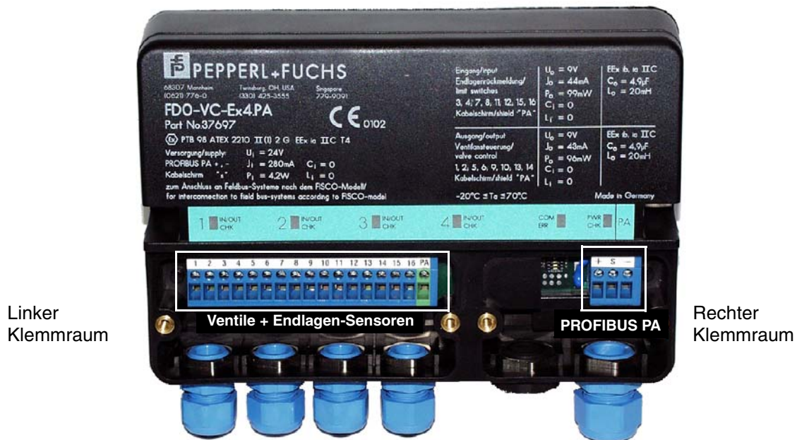
Bild 3.2: Ventilanschaltung mit abgenommenen Klemmraumdeckeln
