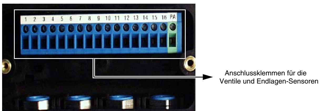
Bild 3.4: Lage und Bezeichnung der Anschlussklemmen für den Ventilanschluss inkl. Endlagenrückmeldekontakte
