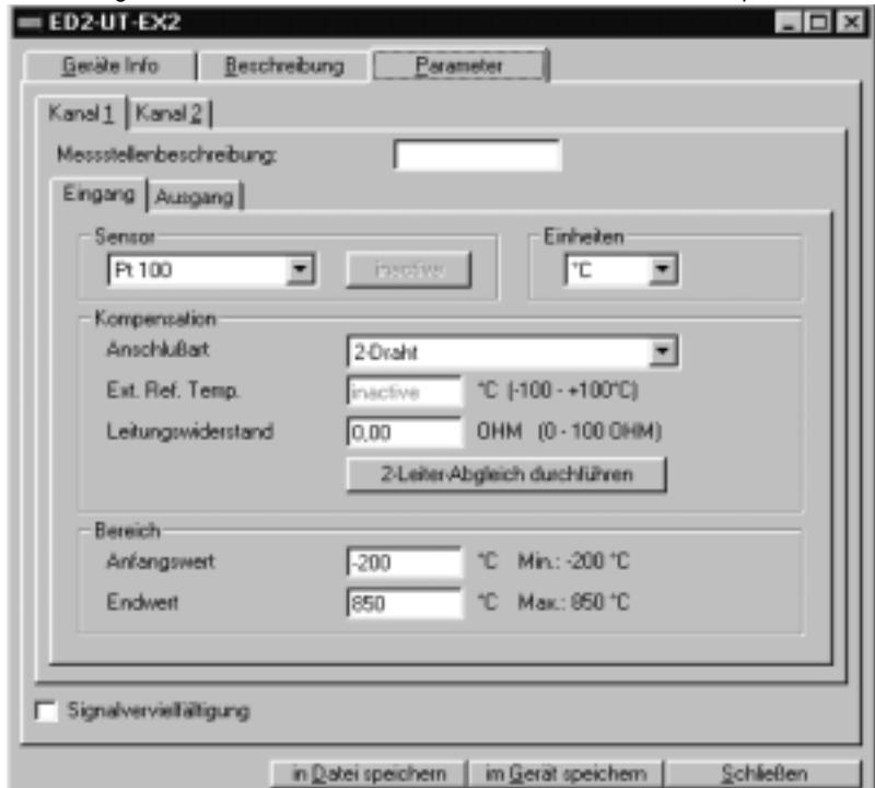
Die in der Maske neu eingestellten Parameter können Sie mit den Schaltflächen unten in der Projektdatei oder im Gerät speichern. Mit der Schaltfläche rechts unten oder der Standard-Schaltfläche  rechts oben schließen Sie das Fenster.
