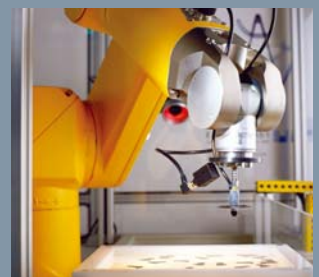
■ 机器人使用编码器监测工具位置和驱动轴移动
