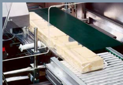
■ 输送带使用编码器监测速度和物体在输送带上移动距离
