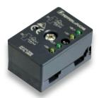
AS-Interface在没有终端电阻时,每段网络可达到100 m;增加终端电阻,可将网络从100 m增加到200 m。 终端电阻在电缆末端可降低反射和改善通讯。对于扁平电缆来说,有2个集成的阻抗值可选。经测试,带有各种拓 扑结构和电缆负载的网络都可以达到200 m的长度。此设备可以显示AS-Interface和AUX的电压。一体化设计的终 端电阻不需要任何附件就可以连接扁平电缆。
