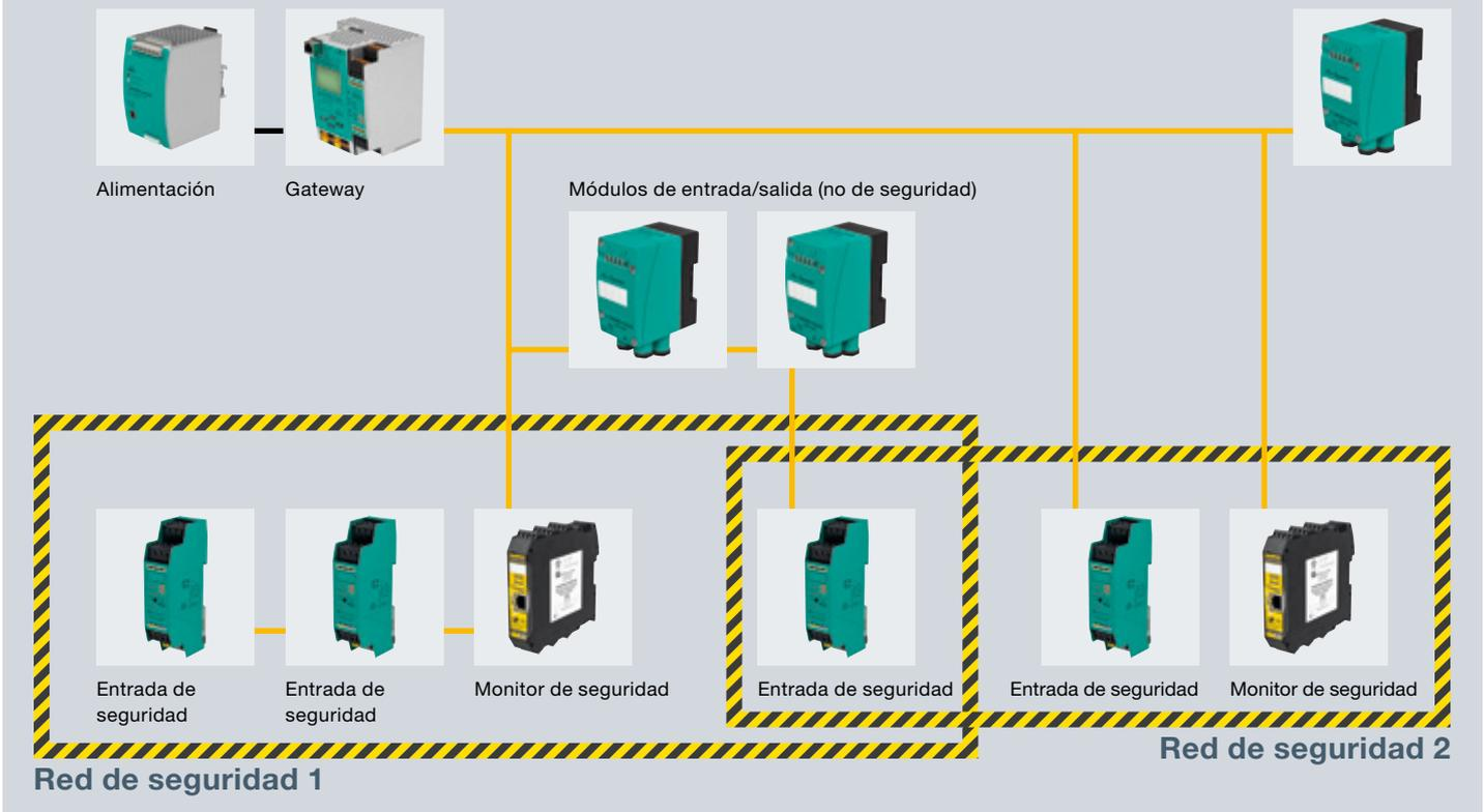
Varios monitores de seguridad KE4 pueden supervisar el mismo módulo de entrada de seguridad en AS-Interface.
