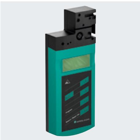
Un programador portátil es la manera más fácil de asignar direcciones a los módulos AS-Interface de la red. También se puede utilizar como una herramienta de diagnóstico para leer el perfil del módulo, configurar parámetros, leer entradas y ajustar salidas.
