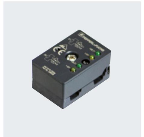
Los terminadores permiten que los segmentos se puedan ampliar desde 100 m hasta un máximo de 200 m. El terminador reduce los reflejos en los extremos del cable y mejora la comunicación. Con la impedancia múltiple integrada y dos opciones para introducir el cable plano, se puede lograr una longitud de red de 200 m con todas las topologías y cargas de cable que se han probado.
