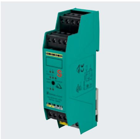
Los módulos de entrada segura KE1 conectan contactos seguros en el armario de control o la caja de conexiones mediante terminales extraíbles y codificados por colores.
