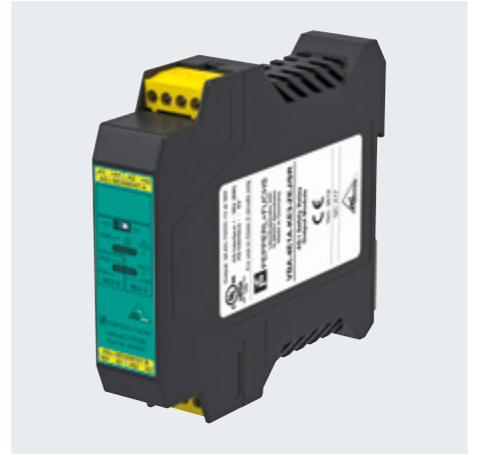
Los repetidores permiten que los segmentos se entrelacen, ampliando la longitud de una red AS-Interface. Pueden conectarse en serie hasta dos repetidores para lograr una ampliación máxima de red de 1000 m en combinación con los terminadores.
