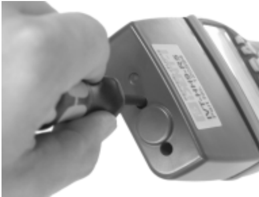
Bild 5.1: Befestigung des Schreib-/Lese-Aufsatzes mittels Schraubendreher
