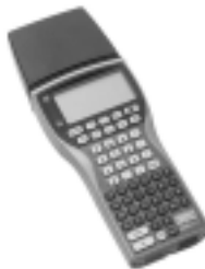
Bild 4.2: Komplettes Hand-Schreib-/Lesegerät IVT-HH9
