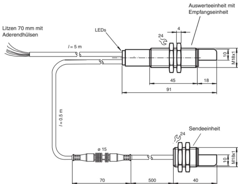
Bild 7.2: Abmessungen
