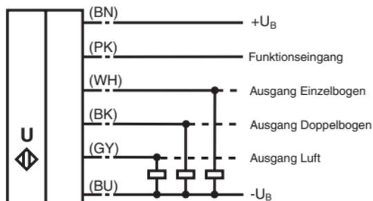
Bild 7.1: Elektrischer Anschluss
