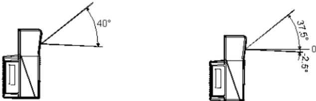
Abbildung 5.3 Maximale Auslenkung und Asymmetrie des Schwingenspiegel
