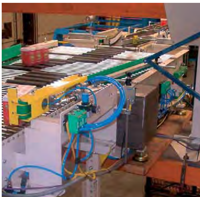
在分拣点的带气动制动器的输送系统
