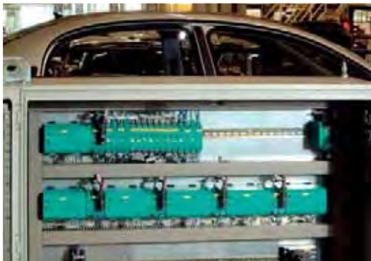
分布式控制的AS-Interface的开关
