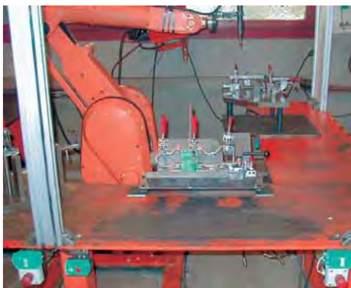
有安全装置和操作按钮的焊接工作站
