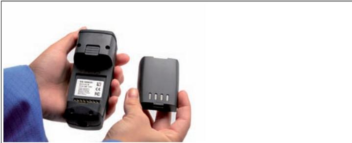
2. Schieben Sie die Kunststoffflasche des Akkus in die dafür vorgesehene Einbuchtung des Handhelds.
