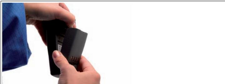
3. Schieben Sie die Arretiervorrichtung nach oben und drücken Sie den Akku hinein.
