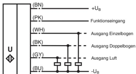
Bild 7.2: Elektrischer Anschluss, Versionen ...-3E2 und ...-3E3
