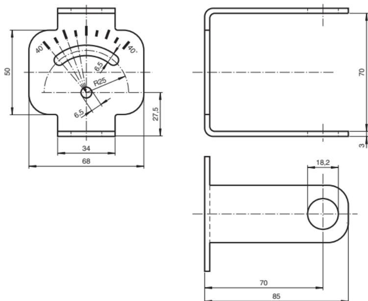
Bild 8.1: Abmessungen Montagehilfe MH-UDB01
