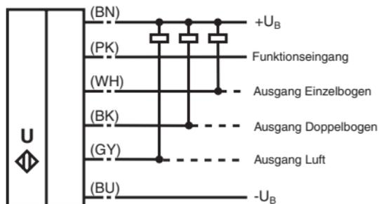
Bild 7.1: Elektrischer Anschluss, Versionen ...-3E0 und ...-3E1
