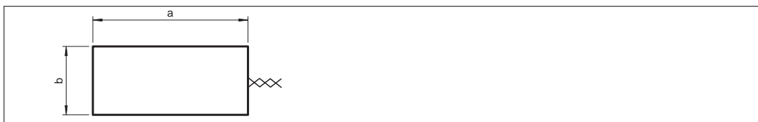
Abbildung 4.1 Skizze zur Berechnung des Schleifenumfangs, z.B.: a = 3 m; b = 1 m; U = 2 \times 3 \text{ m} + 2 \times 1 \text{ m} = 5 \text{ m} ; Windungszahl = 4
