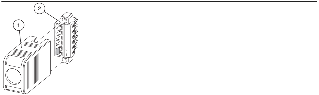
Abbildung 3.12 Vergleichsstelle für Thermoelementmessungen
